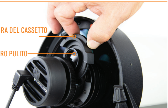
Fig. 15: Afferrare l'impugnatura del cassetto con le dita e tirare verso l'esterno per liberarlo dai magneti.
