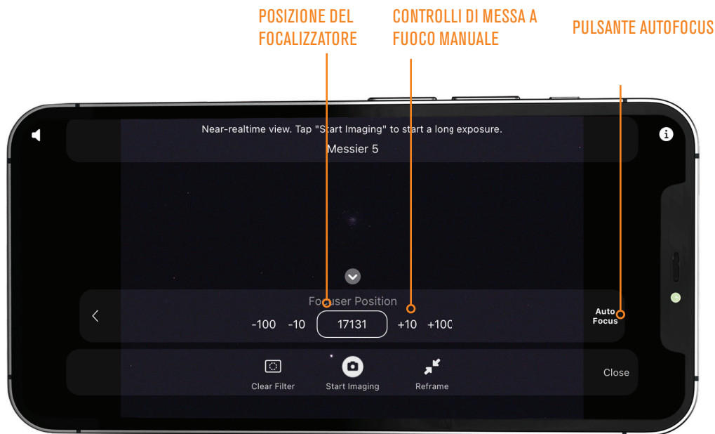
Fig. 12: Utilizza l'icona di messa a fuoco per accedere ai controlli di messa a fuoco automatica e manuale. Anche la posizione del focalizzatore può fornire informazioni utili.
