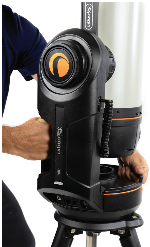
Fig 31 Utilisez les poignées du bras de fourche et du support pour soulever l'Origin.
