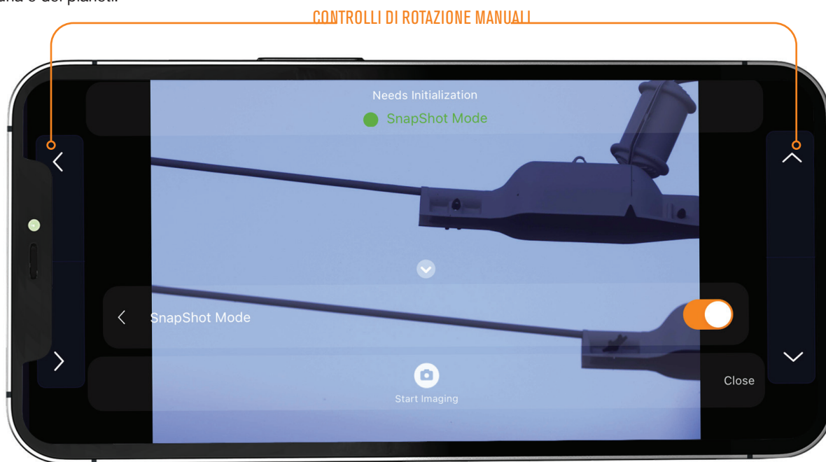
Fig. 23: In modalità SnapShot, si avrà accesso ai controlli di rotazione manuali del telescopio nella Vista Fotocamera. Funzionano meglio con il proprio dispositivo in modalità orizzontale.
