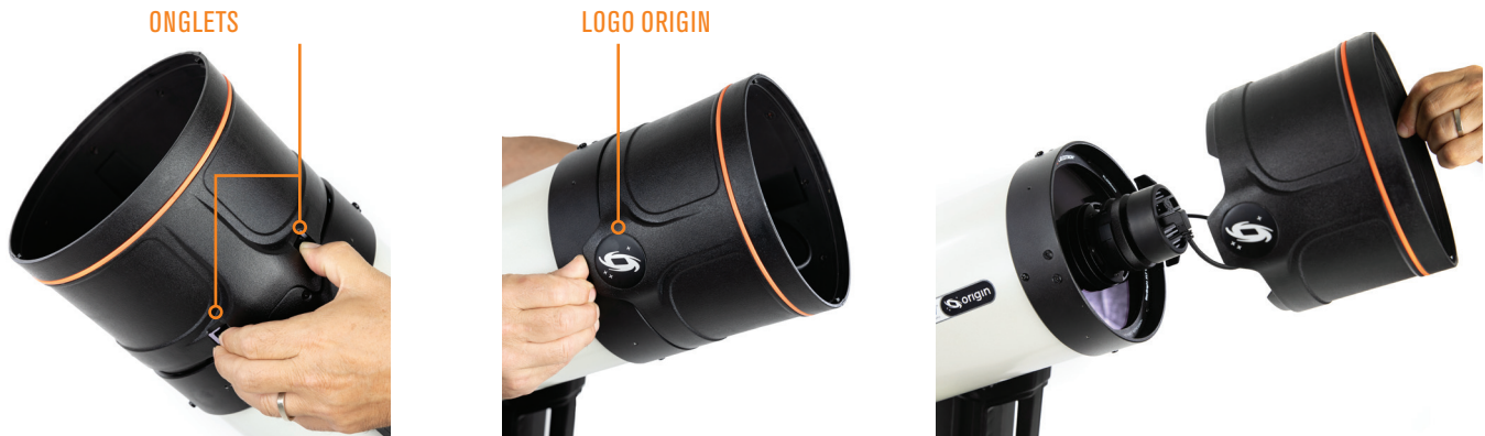
Fig. 13: Retirez le pare-soleil en appuyant d'une main sur les deux languettes tout en poussant vers le haut sous le logo Origin.
