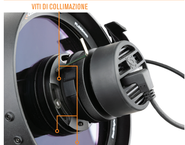
FIG. 34: Regolare l'inclinazione del gruppo lenti (e della fotocamera) con le viti di collimazione.
