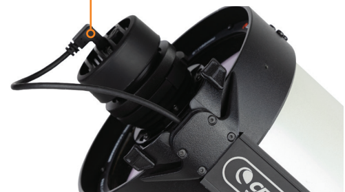
FIG 36: Un extremo del cable de la cámara se conecta con la cámara. El otro extremo se conecta a uno de los puertos USB de Origin.
