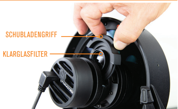
Abb. 15: Fassen Sie den Griff der Schublade mit Ihren Fingern und ziehen Sie ihn nach außen, um ihn von den Magneten zu lösen.
