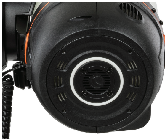
Fig. 8: L'anneau LED sur la cellule arrière d'Origin indique l'état en un coup d'œil.
