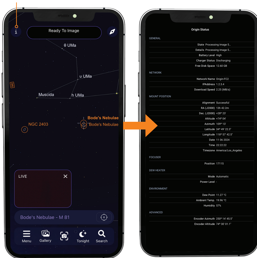
Fig. 10: È possibile accedere alla pagina Stato Origin dall'icona Informazioni nell'angolo in alto a sinistra della Vista Planetario.
