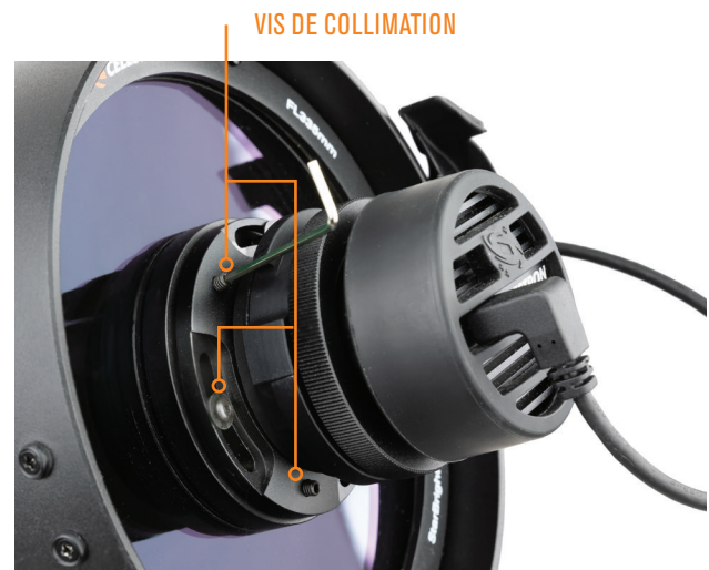
Fig 34 Ajustez l'inclinaison du groupe d'objectifs (et de la caméra) avec les vis de collimation.
