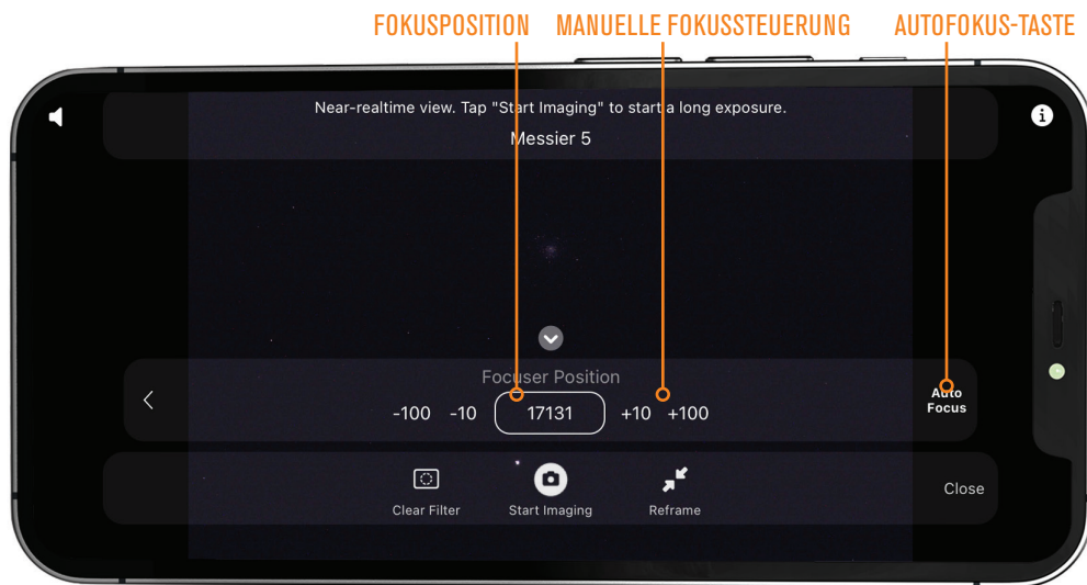
Abb. 12: Verwenden Sie das Fokussymbol, um auf die Autofokus- und manuellen Fokussteuerungen zuzugreifen. Die Fokussierposition kann ebenfalls nützliche Informationen liefern.
