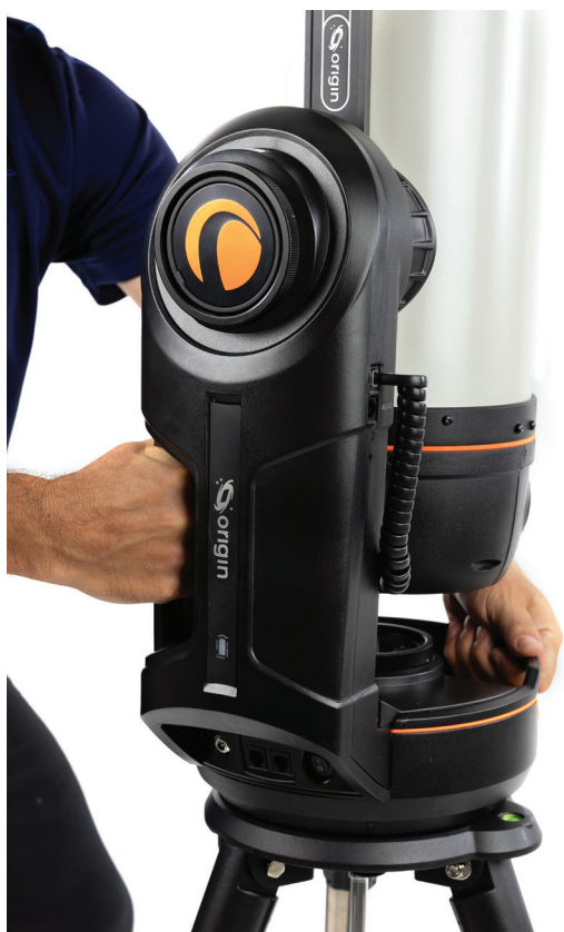
FIG 31: Use las asas del brazo de horquilla y el soporte para levantar Origin.
