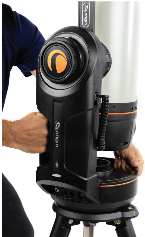
FIG. 31: Utilizzare le maniglie sul braccio della forcella e montare per sollevare Origin.
