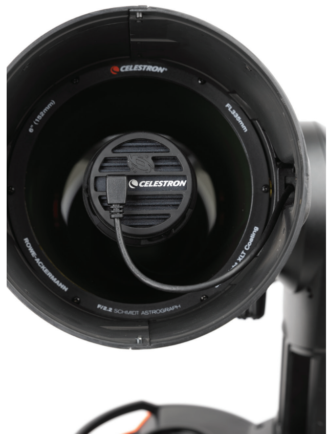
Fig 29 Le cadre plat pris en usine et préchargé sur Origin a été capturé avec l'appareil photo dans l'orientation indiquée. Si vous faites pivoter la caméra à partir de cette orientation, vous devrez produire un nouveau cadre plat.
