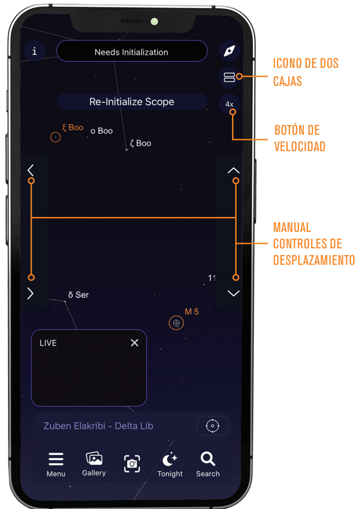
FIG 24: Mostrar controles del telescopio le proporciona controles de desplazamiento manual en la Vista de planetario. Use el botón Velocidad para cambiar la velocidad de desplazamiento.
