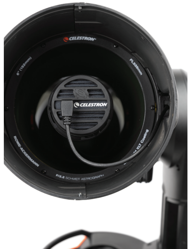
FIG. 29: Il flat frame acquisito in fabbrica e precaricato su Origin è stato catturato con la fotocamera nell'orientamento mostrato. Se ruoti la fotocamera da questo orientamento, dovrai produrre un nuovo flat frame.
