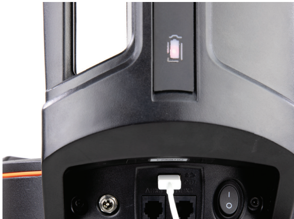
FIG 38: Puede usar el puerto de carga USB en el soporte Origin para cargar su dispositivo en el campo.
