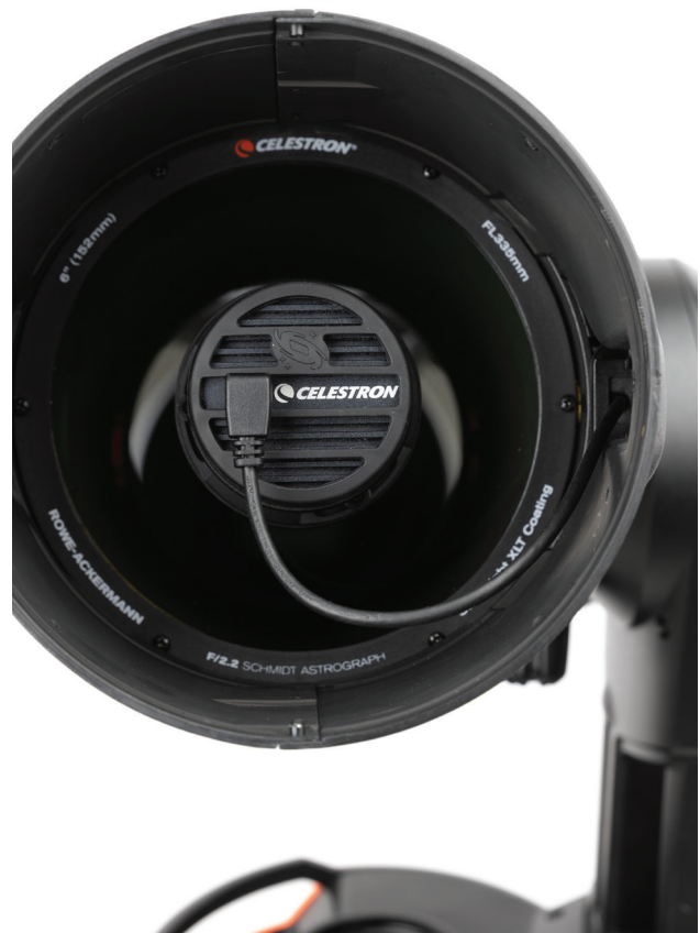
FIG 29: El fotograma plano tomado en fábrica y precargado en Origin se capturó con la cámara en la orientación mostrada. Si rota la cámara a una orientación distinta, deberá producir un nuevo fotograma plano.
