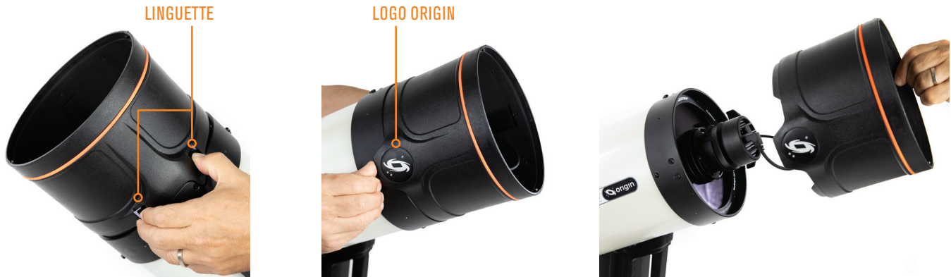
Fig. 13: Rimuovi il paraluce premendo le due linguette con una mano mentre spingi verso l'alto sotto il logo Origin.
